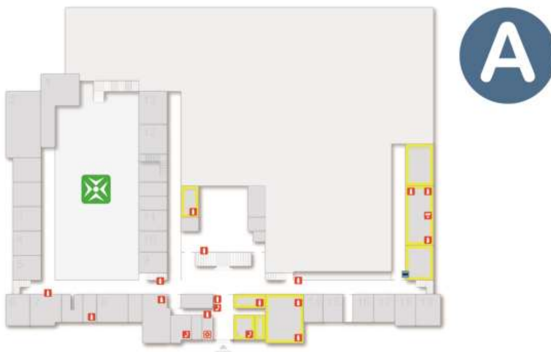
Fig. 5 Extintores e locais de risco no piso A
