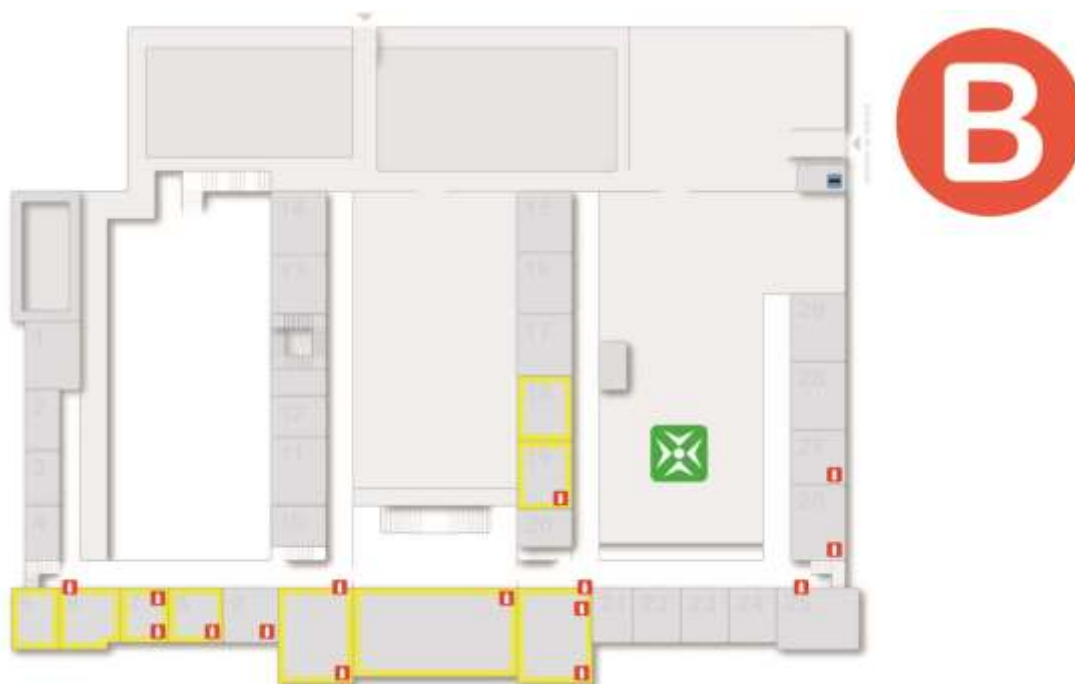
Fig. 6 Extintores e locais de risco no piso B
